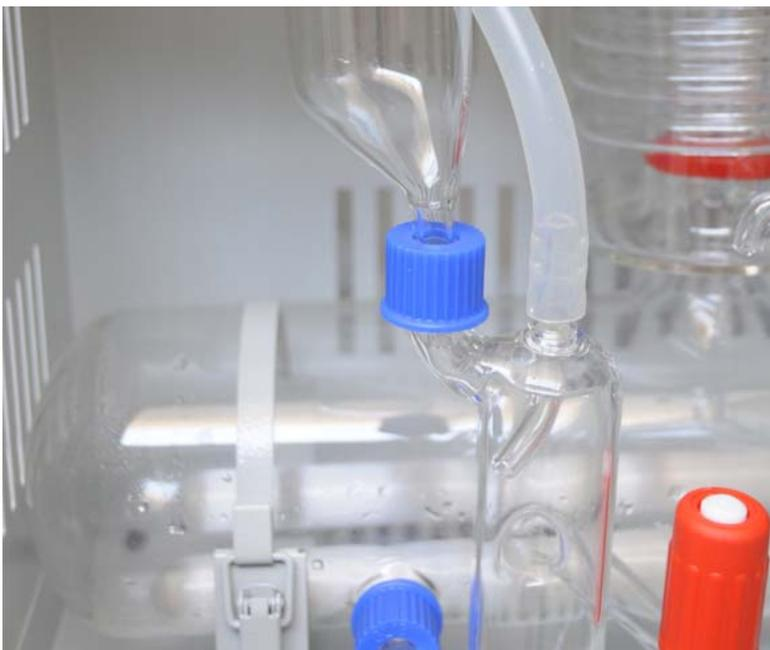
Los elementos de vidrio están fabricados en vidrio borosilicato 3.3 y las dos resistencias calefactoras que incorpora están protegidas por una vaina de cuarzo, características ambas que garantizan un uso intensivo del equipo y una larga vida útil.
