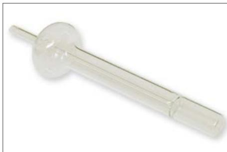
[7] Embudo integrado para la adición de productos químicos de limpieza (ácido acético, ácido clorhídrico, etc) para una rápida descalcificación del interior, resultando una operación de limpieza simple y segura sin necesidad de desmontar ninguno de los elementos de vidrio. Un grifo tipo Rotaflow con llave de PTFE permite el vaciado completo tras la limpieza
