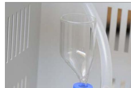
[8] Soporte de pared / Puede operar sobre la mesa de laboratorio o ser montado en la pared mediante el adaptador suministrado con el equipo
