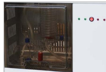
[2] Puertas superior y lateral / Garantizan la accesibilidad al interior para montaje/desmontaje de las partes que componen el equipo
